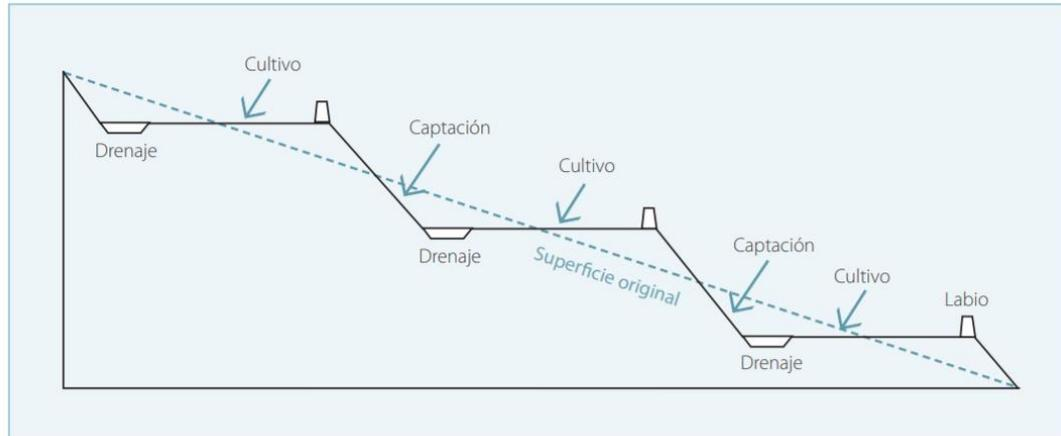
Imagen 31. Esquema de sistema de microcaptación en terrazas de banco. (FAO, 2013).
